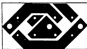
Obr. 8. Deska s plošnými spoji C (Q39)
